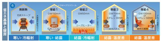
■上記、等級3までの住宅は、断熱不良で暖房経費が非常に高い。特にシーズヒータなどは月額6万円も電気料が必要でした。一般住宅では炊事=ガス、風呂=灯油・ガス、暖房=灯油・電気、照明の電気と言うように、ガス・灯油・電気の3種類の燃料を消費し、暖冷房+光熱費+生活電気の合計は、1家庭(4~6人)月額平均26,000円以上と言われていました。現在も築30年以上の住宅はほぼ同じです。断熱性能・気密性能など、住宅の性能の違いと、給湯器(エコキュート等)の違いで、光熱費の差は非常に大きくなります。
