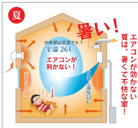
●断熱・気密性能が低い住宅の空気の流れ
