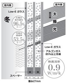
トリプルガラス樹脂サッシの性能は、ほとんど壁性能と変わらない高性能です。今までは、メーカーでも寒冷地向けの出荷が主でしたが、寒冷地の断熱よりも日射遮蔽が重要な酷暑地域の遮熱に、効果的であることが分かって参りました。価格的に高価だったので、積極的には、お勧めできませんでしたが、今後はご希望があれば、積極的に採用したいと考えています。
